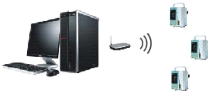
Sistema de monitoreo de infusión (Opcional), el estado de cada bomba se muestra en tiempo real en la estación central a través de transmisión inalámbrica.
